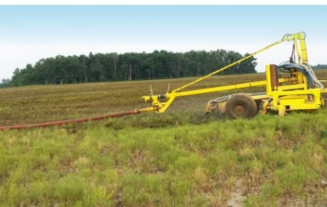
Шланг Manure Drag PU создан специально для сложных условий эксплуатации в качестве буксируемого шланга для перекачивания жидких удобрений и навоза. Внутренний и внешний слой шланга выполнен из термопластичного полиуретана (TPU BASF), что гарантирует высшую на сегодняшний день прочность, стойкость к перекачиваемому продукту, неприхотливые условия хранения.
